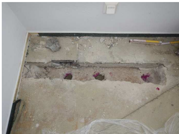
Foto č.52, 53 – sonda NV 12 – 4.NP- m.č. B417 – celkový pohled a detail výztuže; zk. karbonatace
