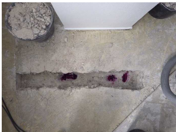
Foto č.48, 49 – sonda NV 10 – 3.NP, B302 – celkový pohled, detail zk. karbonatace
