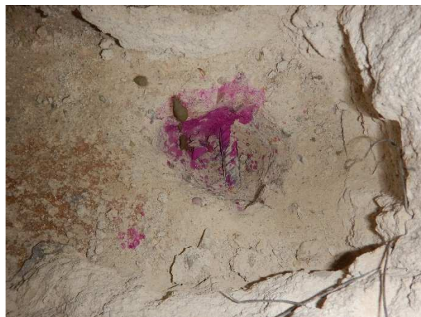
Foto č.52, 53 – sonda NV 12 – 4.NP- m.č. B417 – celkový pohled a detail výztuže; zk. karbonatace
