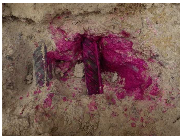
Foto č.50, 51 – sonda NV 11 – 3.NP- m.č. B314 – celkový pohled a detail výztuže; zk. karbonatace
