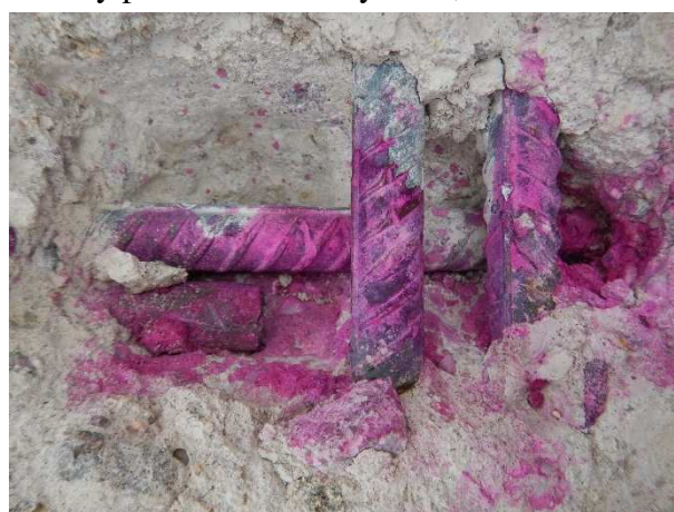
Foto č.44, 45 – sonda NV 8 – 4.NP- m.č. C416 – celkový pohled a detail výztuže; zk. karbonatace
