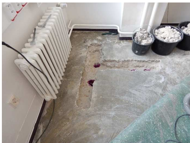
Foto č.32, 33 – sonda NV 2 – 1.PP- m.č. C027- celkový pohled a detail výztuže; zk. karbonatace
