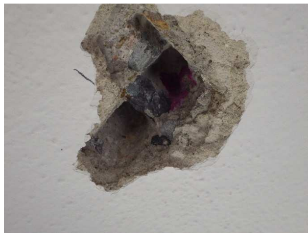
Foto č.66, 67 – sonda NV 20 – 2.NP- m.č. B209 –detail výztuží; zk. karbonatace
