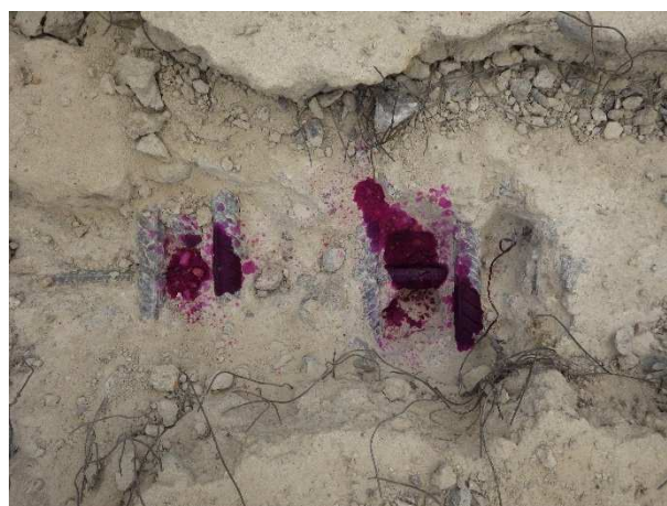
Foto č.46, 47 – sonda NV 9 – 5.NP- m.č.C505 – celkový pohled a detail výztuže; zk. karbonatace
