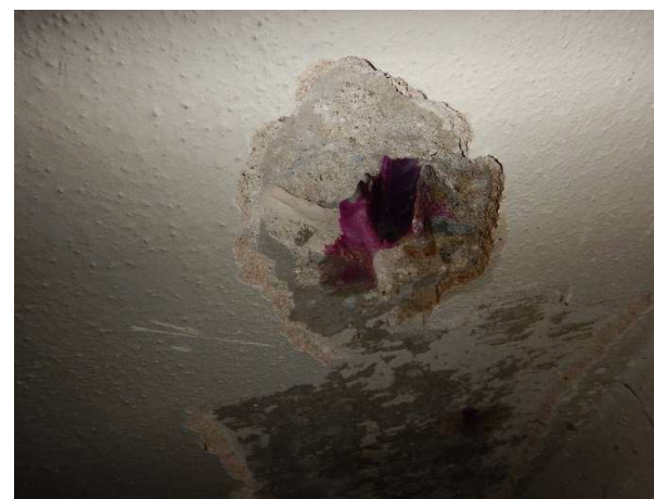
Foto č.68, 69 – sonda NV 21 – 1.PP- m.č. B007 – celkový pohled a detail výztuže; zk. karbonatace
