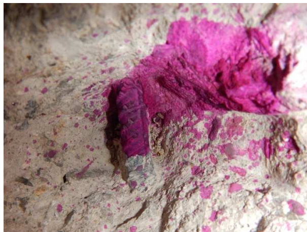
Foto č.60, 61 – sonda NV 16 – 2.NP- m.č. B204 – celkový pohled a detail výztuže; zk. karbonatace
