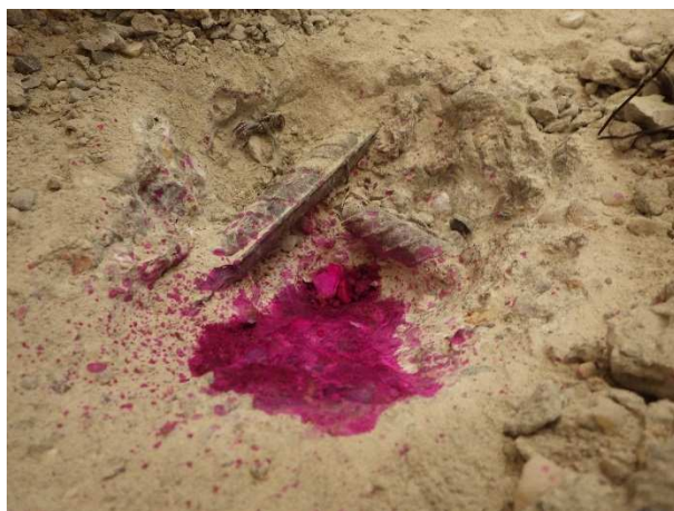
Foto č.34, 35 – sonda NV 3 – 1.NP- m.č.C122 – celkový pohled a detail výztuže; zk. karbonatace
