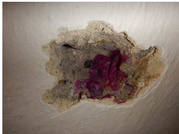
Foto č.64 – sonda NV 18 – 2.NP- m.č. B204- detail ; zk. karbonatace
