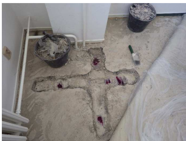
Foto č.46, 47 – sonda NV 9 – 5.NP- m.č.C505 – celkový pohled a detail výztuže; zk. karbonatace
