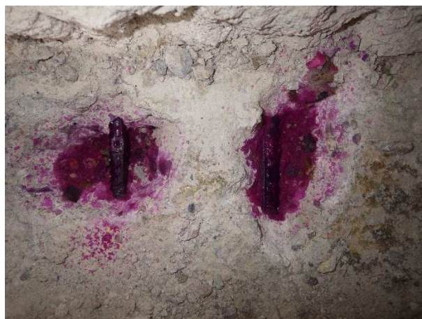
Foto č.48, 49 – sonda NV 10 – 3.NP, B302 – celkový pohled, detail zk. karbonatace
