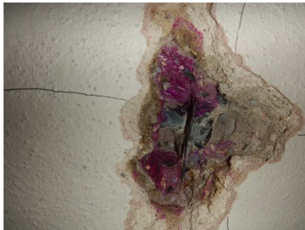
Foto č.72, 73 – sonda NV 23 – 1.PP- m.č. B007 – celkový pohled a detail výztuže; zk. karbonatace
