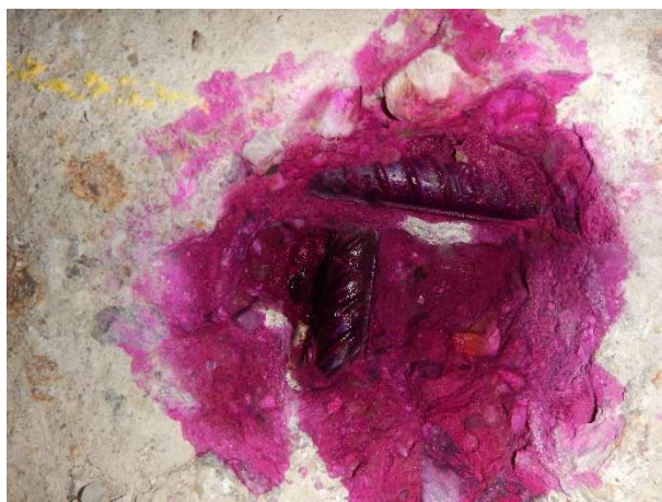
Foto č.32, 33 – sonda NV 2 – 1.PP- m.č. C027- celkový pohled a detail výztuže; zk. karbonatace
