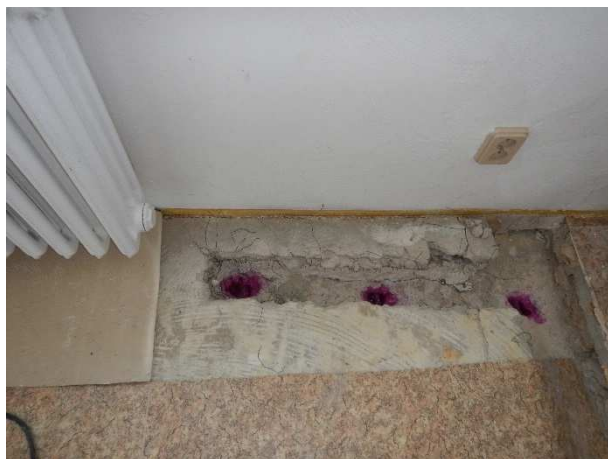
Foto č.40, 41 – sonda NV 6 – 1.NP- m.č.C122 – celkový pohled a detail výztuže; zk. karbonatace
