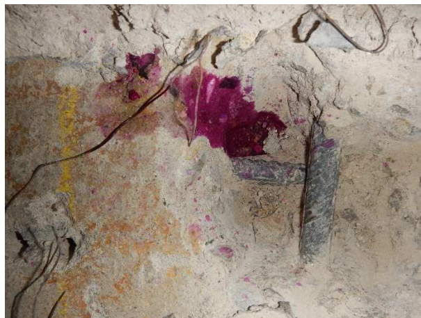
Foto č.54, 55 – sonda NV 13 – 1.NP- m.č. B106 – celkový pohled a detail výztuže; zk. karbonatace
