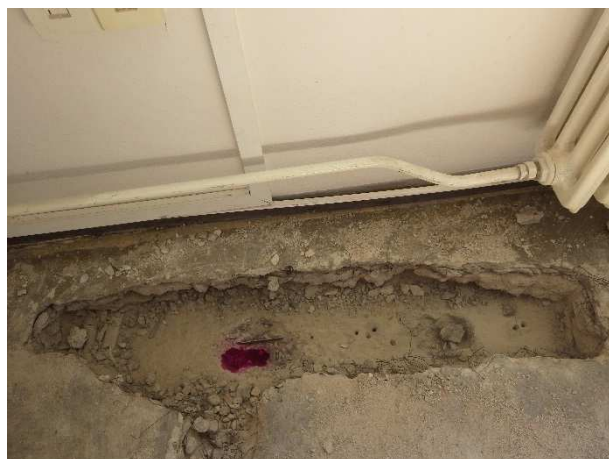
Foto č.34, 35 – sonda NV 3 – 1.NP- m.č.C122 – celkový pohled a detail výztuže; zk. karbonatace
