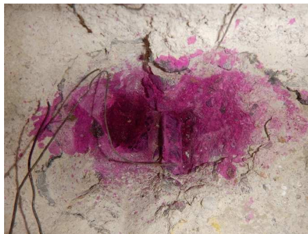
Foto č.40, 41 – sonda NV 6 – 1.NP- m.č.C122 – celkový pohled a detail výztuže; zk. karbonatace
