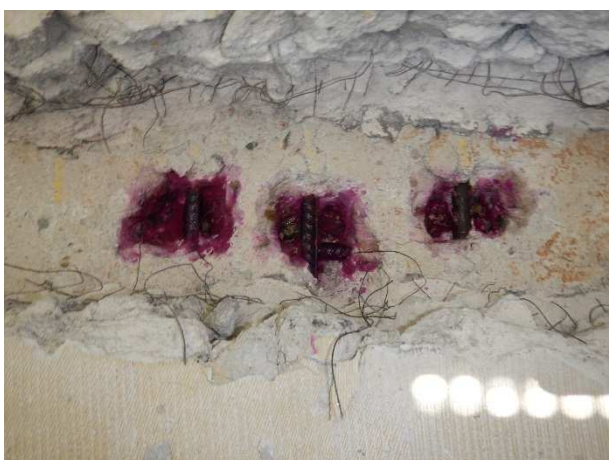
Foto č.56, 57 – sonda NV 14 – 1.NP- m.č. B106 – celkový pohled a detail výztuže; zk. karbonatace
