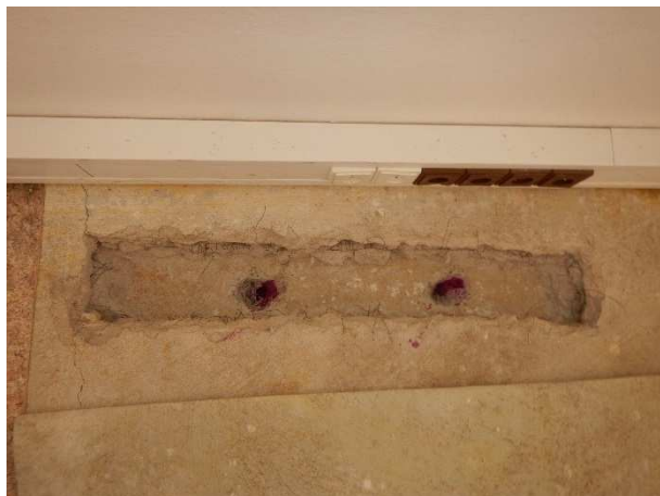
Foto č.60, 61 – sonda NV 16 – 2.NP- m.č. B204 – celkový pohled a detail výztuže; zk. karbonatace
