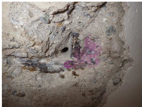
Foto č.36, 37 – sonda NV 4 – 4.NP- m.č.C416 – celkový pohled a detail výztuže; zk. karbonatace
